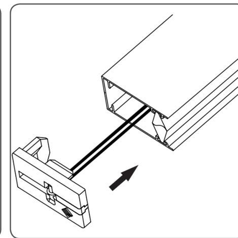
Infilare la guida per la linguetta della testata (può essere necessario uno sforzo per vincere la tensione della fune).
